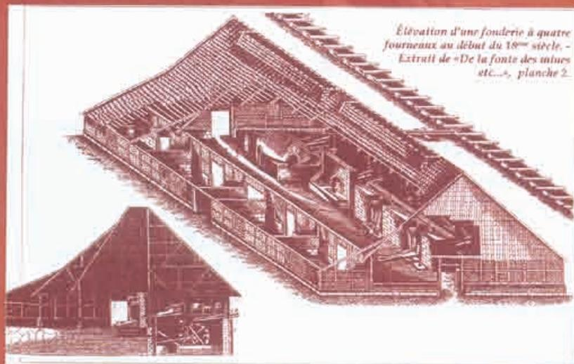
Élévation d'une fonderie à quatre fourneaux au début du 18<sup>ème</sup> siècle. - Extrait de «De la fonte des mines etc...», planche 2.
