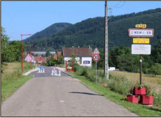
La limitation de vitesse : pour réduire la vitesse à l'entrée du village et sur tout le trajet jusqu'à la mairie, 3 chicanes et 2 plateaux ont été installés en plus des panneaux de limitation de vitesse à 30 Km/h.
